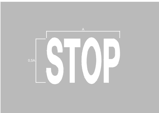
E-73b Stop en un carril bicicleta Amplada Carril (L) Amplada Logo (A) 80 < L < 100 80 100 < L < 120 95 120 < L < 160 110 L > 160 150
