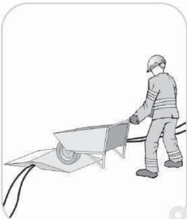
protección de conductores
