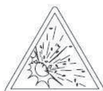
RIESGO DE EXPLOSION
