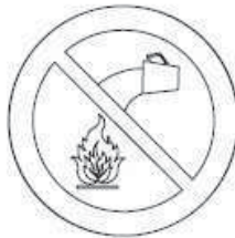
PROHIBIDO APAGAR CON AGUA
