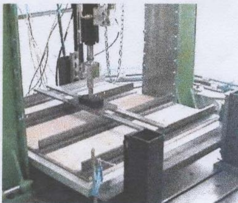
Fotografía 3: Realización del ensayo de resistencia al viento (método A).
