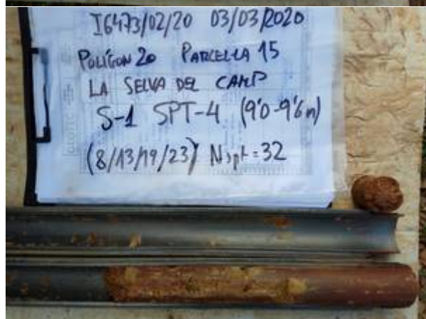
Vistes dels materials del subsòl extrets en quatre assaigs SPT realitzats al llarg del sondeig S-1
