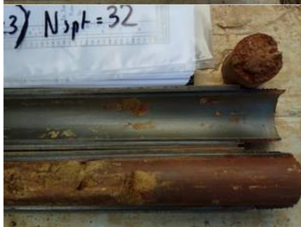
Vistes dels materials del subsòl extrets en quatre assaigs SPT realitzats al llarg del sondeig S-1
