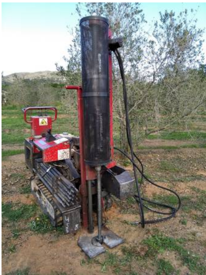
Vistes dels tres sondeigs realitzats a la zona objecte d'estudi, S-1 del tipus rotació helicoidal, i P-2 i P-3 del tipus DPSH
