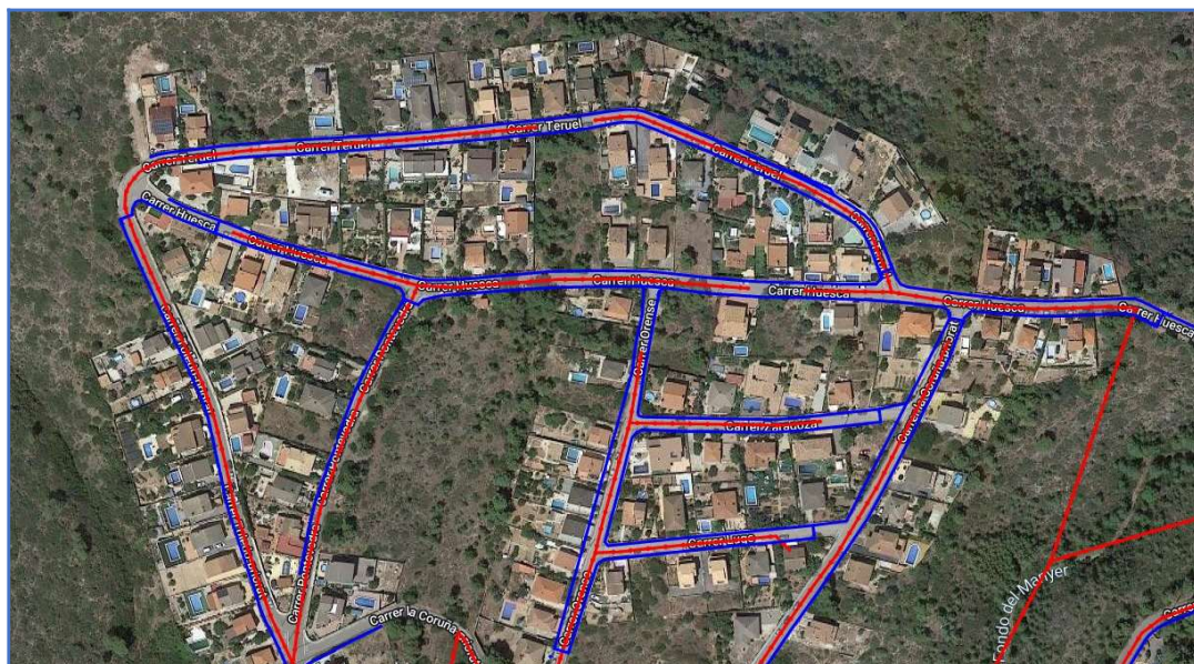
Imatge 1. Xarxa de distribució d'aigua (color blau), i xarxa de sanejament (color vermell) a zona Carrer Teruel
