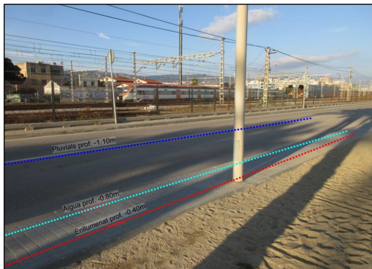
Figura 12: Canalitzacions detectades amb GPR
