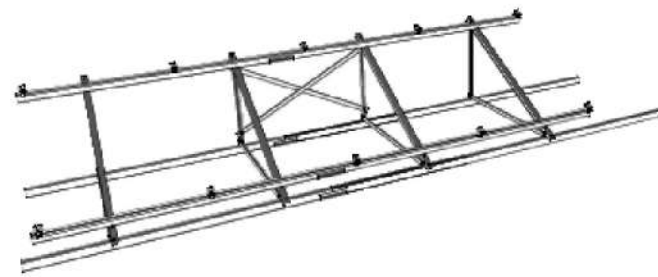
VISTA ESTRUCTURA DE SUPORT PLAQUES FOTOVOLTAIQUES
