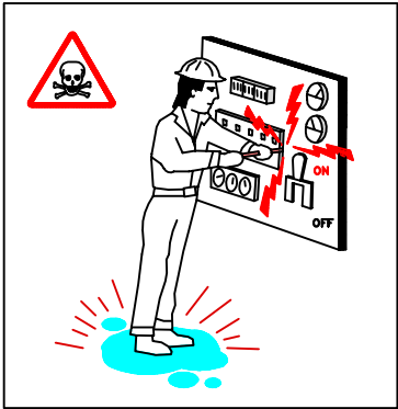
REPARACIO D' EQUIPS SOTA TENSIO
