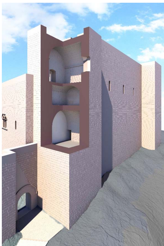
Fig. 6. Recreación virtual de la torre del tesoro que muestra su estructura interna en tres niveles.
