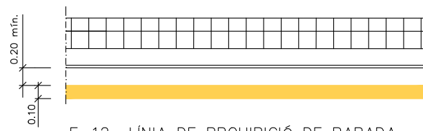
E-12 LÍNIA DE PROHIBICIÓ DE PARADA
