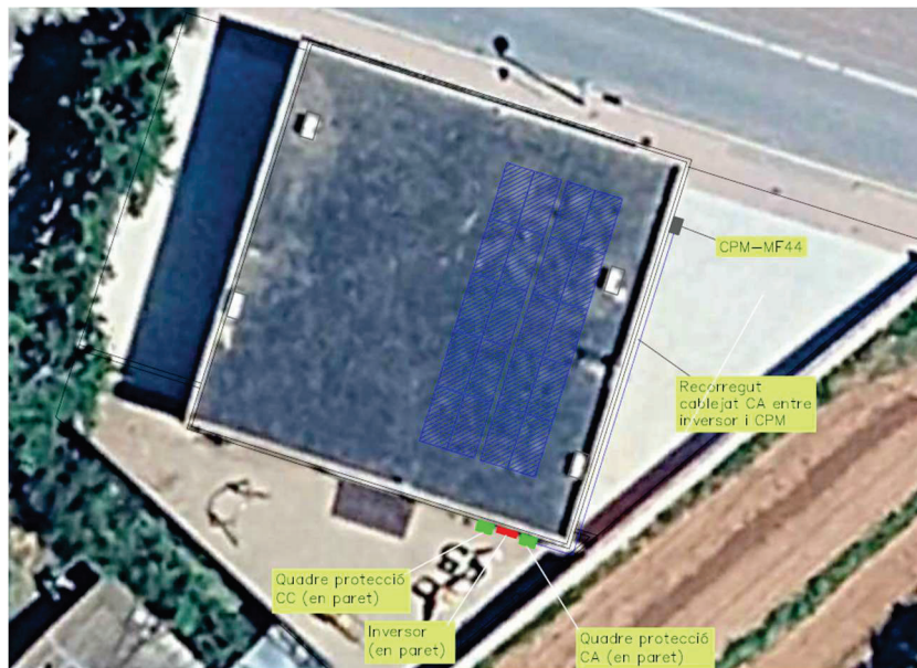
Ubicació captadors, inversor i proteccions en planta.
