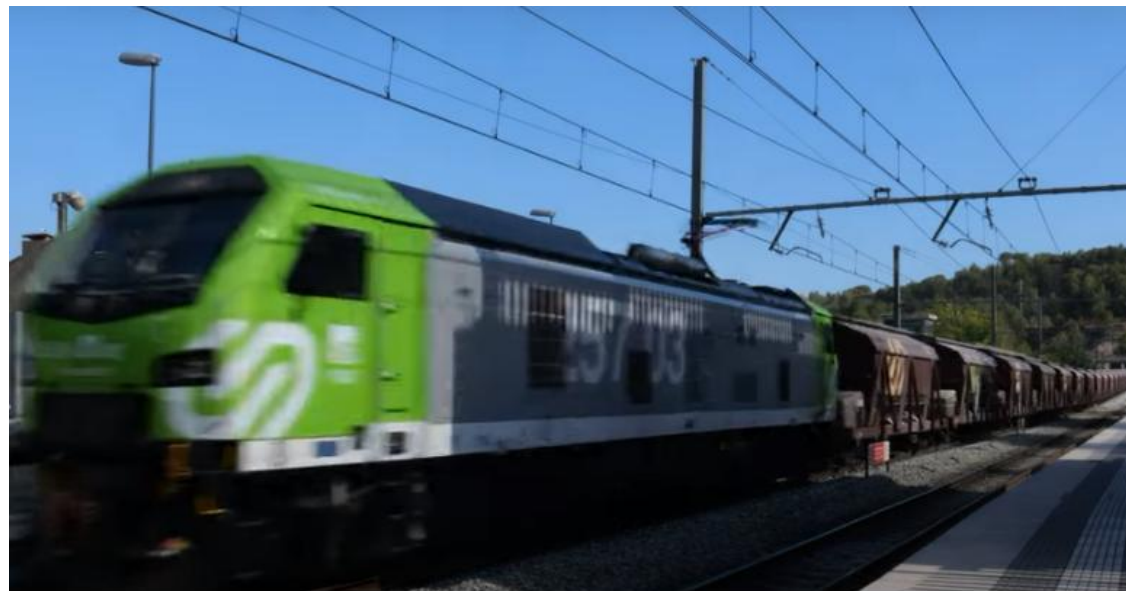
Imatge 1 - Transport de potassa amb màquina bimodal dièsel i elèctrica de 257/03 de FGC.
