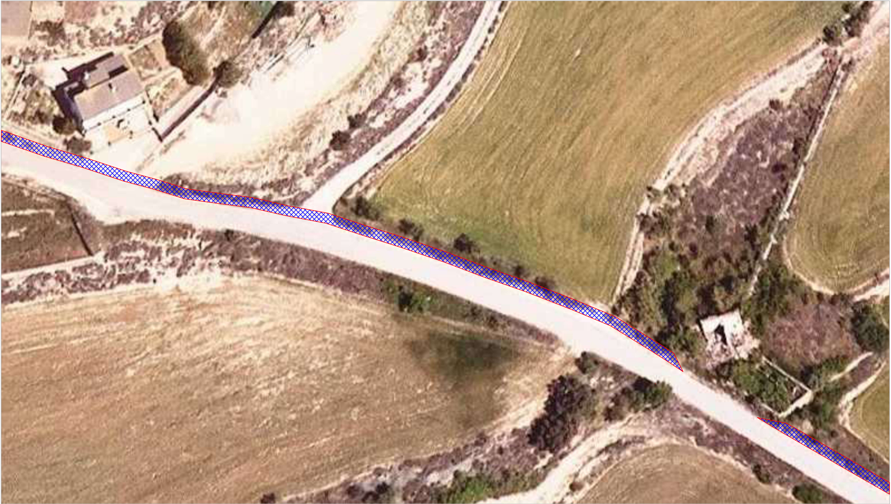
EIXAMPLAMENT DEL VIAL D'ACCÉS AL NUCLI DE LA MORANA AMB PAVIMENT DE FORMIGÓ, LONGITUD TOTAL 531 m LINIALS, AMPLADA MITJA 1,25 m, GRUIX PAVIMENT DE FORMIGÓ 17 cm
