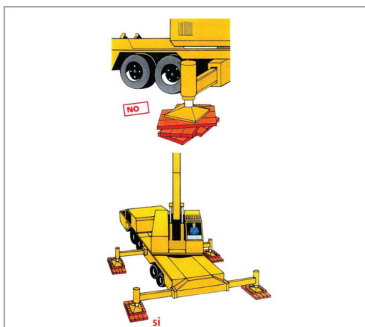
Col·locació estabilizadors recolçaments
