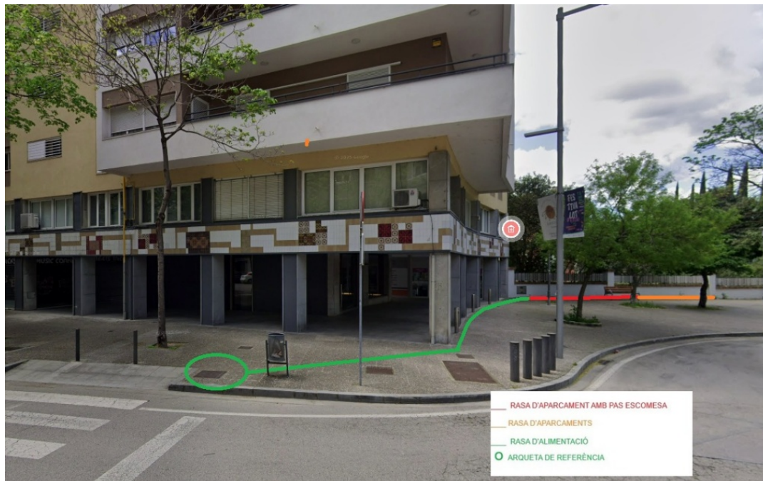
Imatge 41_03: Recorregut d'escomesa des d'arqueta de referència fins a estació per tram 1 rasa escomesa.
