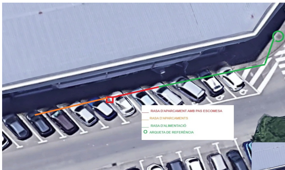
Imatge 40_03: Previsió de recorregut línia d'alimentació de l'estació 40 des de tòtem fins arqueta de referència.
