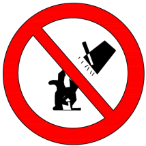
PROHIBIT APAGAR AMB AIGUA
