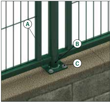
PLACA BASE Possibilitat d'incorporar placa base, per a instal·lar els postes sobre mur de formigó i en reixats d'altura < 2m00. Mesures de la placa 120x120x8mm.
