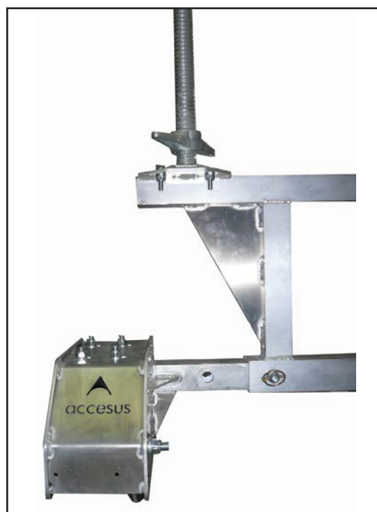
Posición ambas rueda para ancho de via 1674mm.
