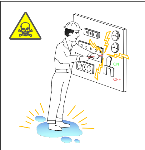
REPARACIÓ D'EQUIPS SOTA TENSIO
