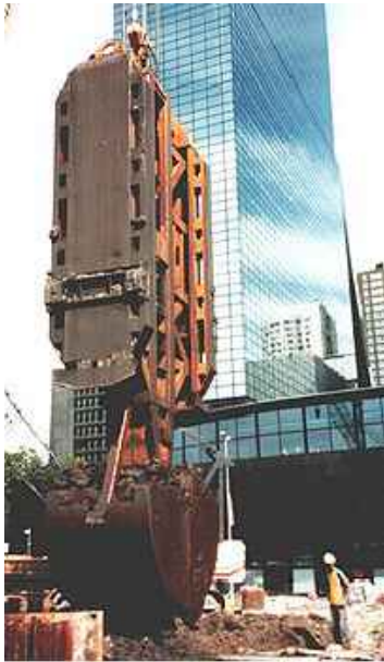
Cullera bivalva amb cable 1. Suspensió 2. Cos 3. Politges 4. Valves o mandíbules
