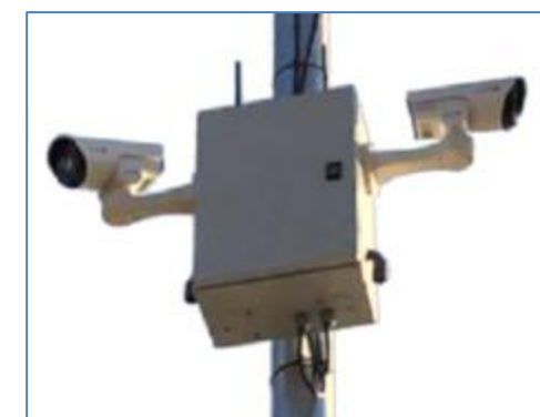
Il·lustració 5: Exemple d'equip de reconeixement de matrícules amb dues carcasses
