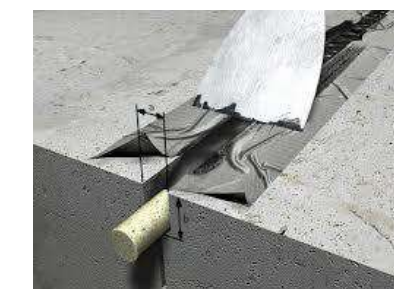
Figura 32. Imatge segellat de junta de dilatació amb cordó obturador en el fons del tall.
