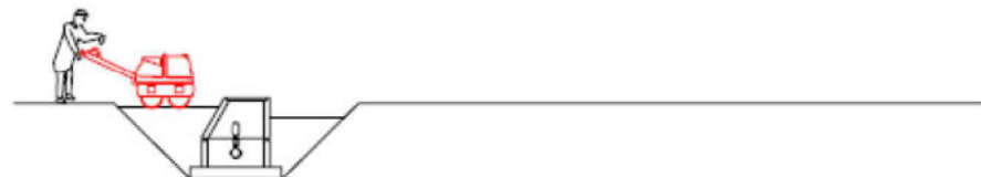
7. Compactació de terres al voltant del pou
