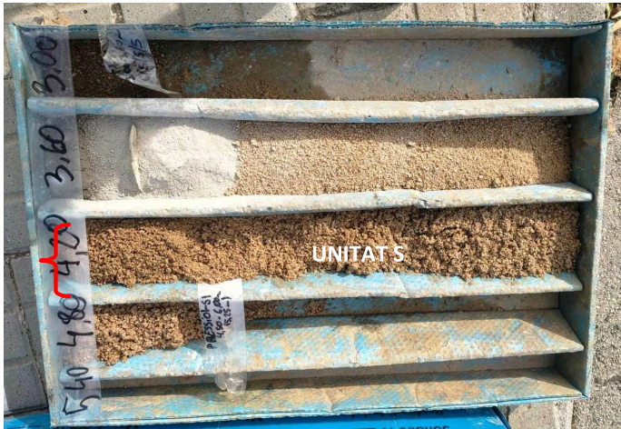
Fotografia 22. Detall de unitat S al sondeig S1 (7/10/2024)
