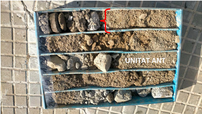
Fotografia 20. Detall de unitat ANT al sondeig S2 (9/10/2024)
