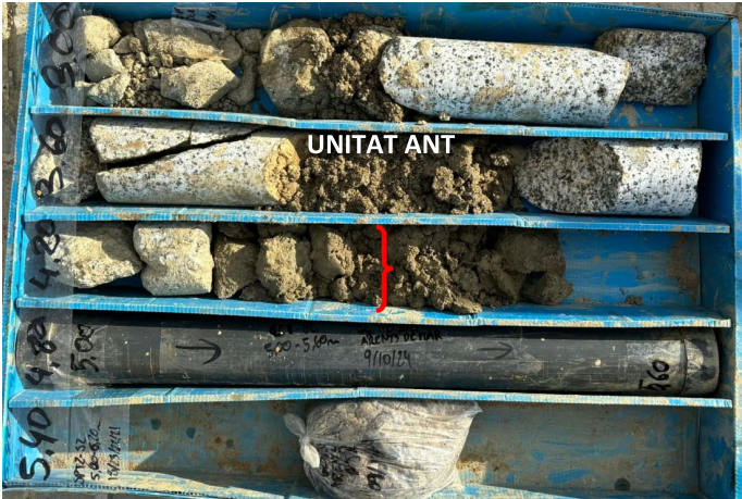
Fotografia 21. Detall de unitat ANT al sondeig S2 (9/10/2024)
