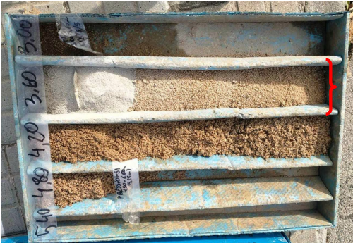
Fotografia 19. Detall de unitat AL-ANT al sondeig S1 (7/10/2024)
