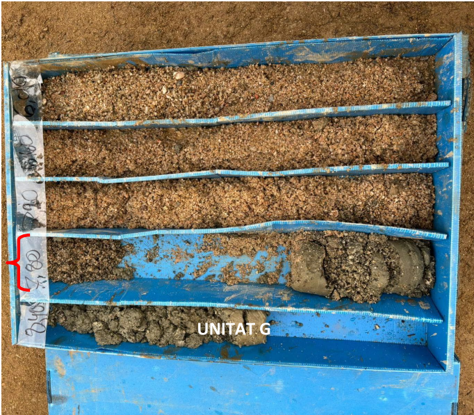
Fotografia 26. Detall de unitat G al sondeig S1 (7/10/2024)
