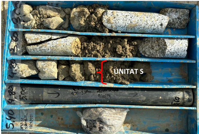
Fotografia 24. Detall de unitat S al sondeig S2 (9/10/2024)
