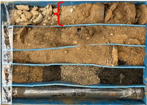
Fotografia 18. Detall de unitat AL-ANT al sondeig S1 (7/10/2024)
