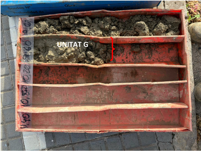
Fotografia 27. Detall de unitat G al sondeig S1 (7/10/2024)
