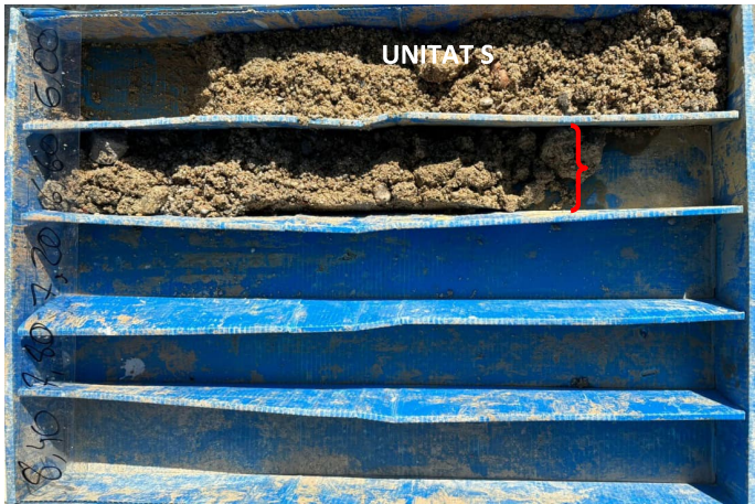
Fotografia 25. Detall de unitat S al sondeig S2 (9/10/2024)
