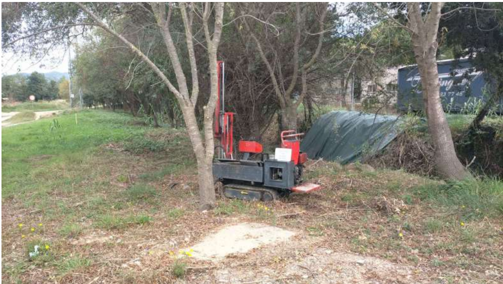
Fotografia 5. Assaig de penetració dinàmica DPSH PD1 (22/10/2024)
