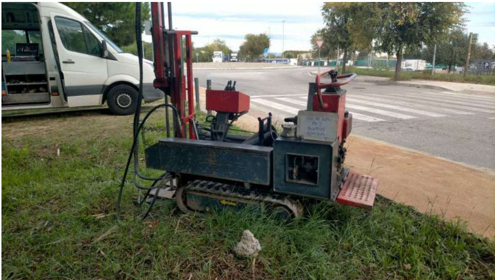
Fotografia 6. Assaig de penetració dinàmica DPSH PD2 (22/10/2024)
