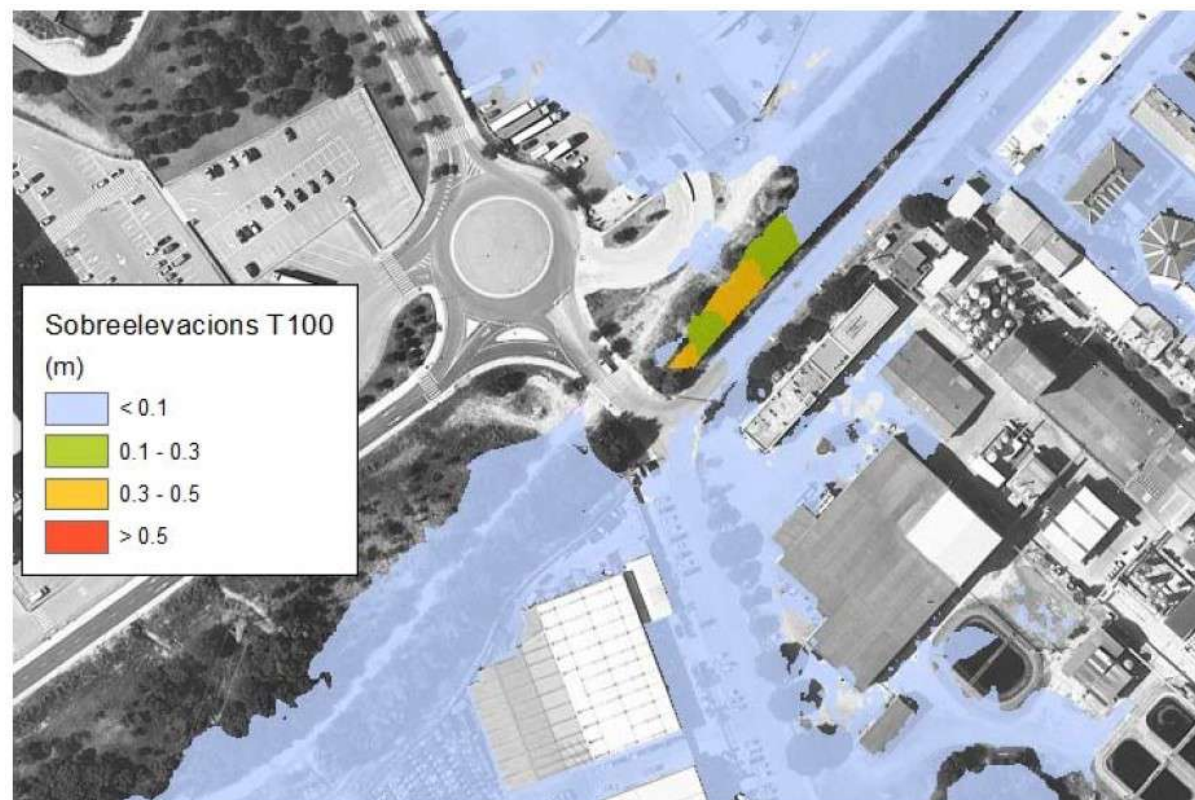
Figura 30: Sobreelevaciones generades per a Q_{100} en l'escenari de projecte respecte l'actual.
