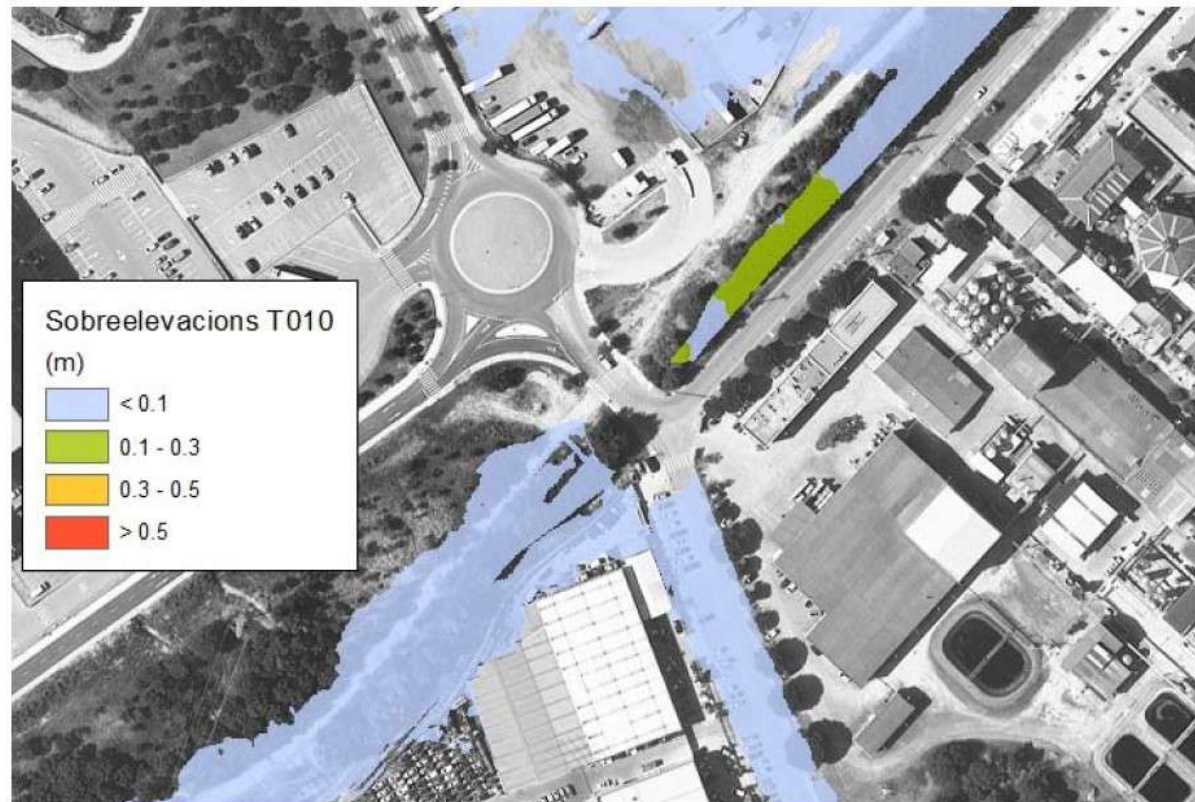
Figura 29: Sobreelevaciones generades per a Q_{010} en l'escenari de projecte respecte l'actual.
