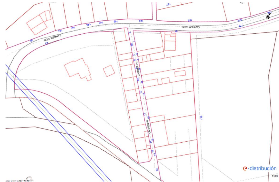
Figura 77. Xarxa existent de mitja tensió.
