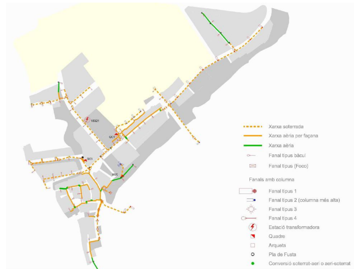
Figura 81. Plànol xarxa enllumenat públic existent.
