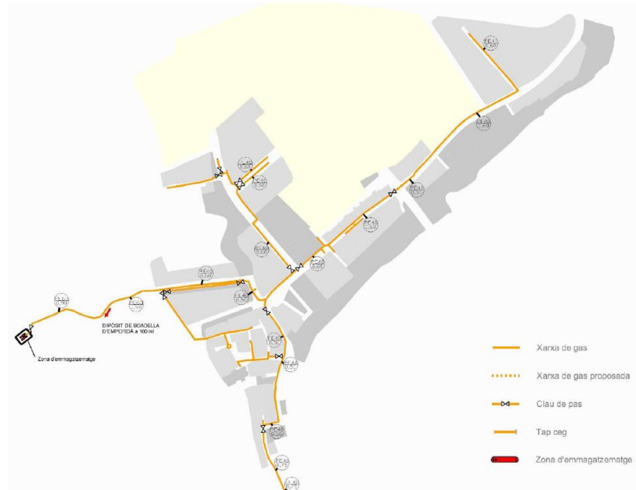
Figura 19. Plànol xarxa de gas existent.
