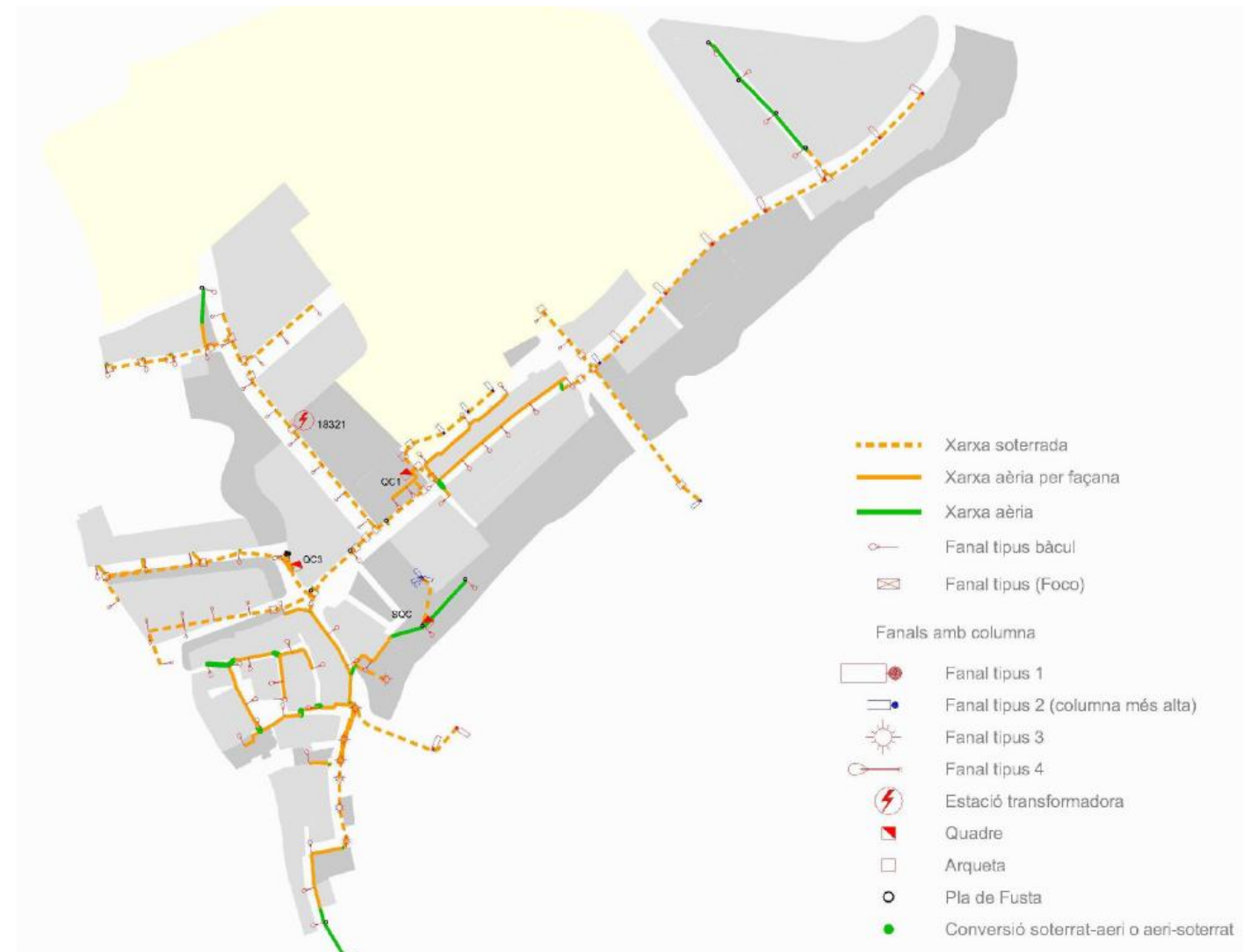
Figura 15. Plànol xarxa enllumenat públic existent.
