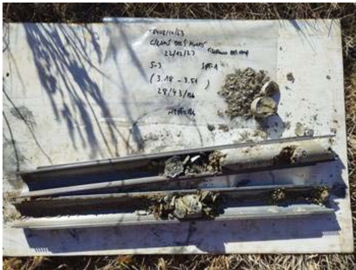
Vistes dels materials del subsòl extrets en un assaig SPT realitzat al llarg del sondeig S-3.
