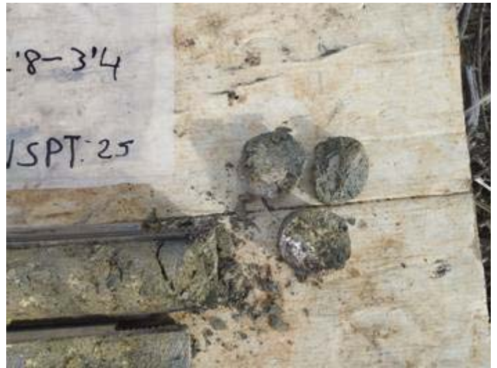
Vistes dels materials del subsòl extrets en un assaig SPT realitzat al llarg del sondeig P-2.
