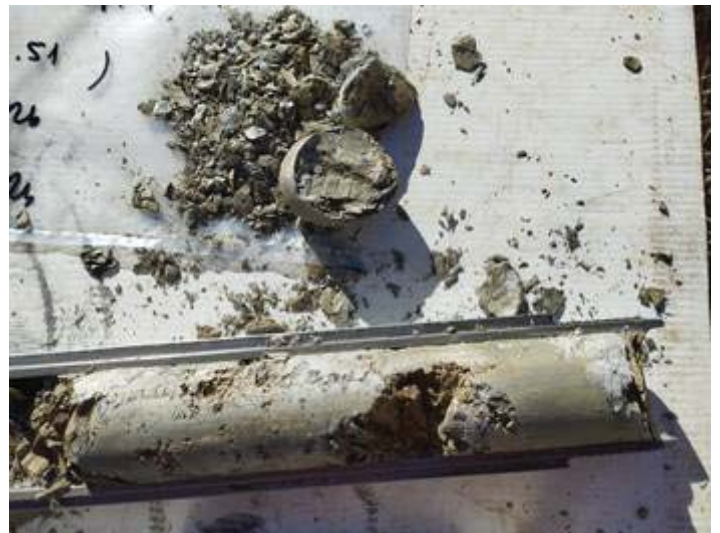
Vistes dels materials del subsòl extrets en un assaig SPT realitzat al llarg del sondeig S-3.
