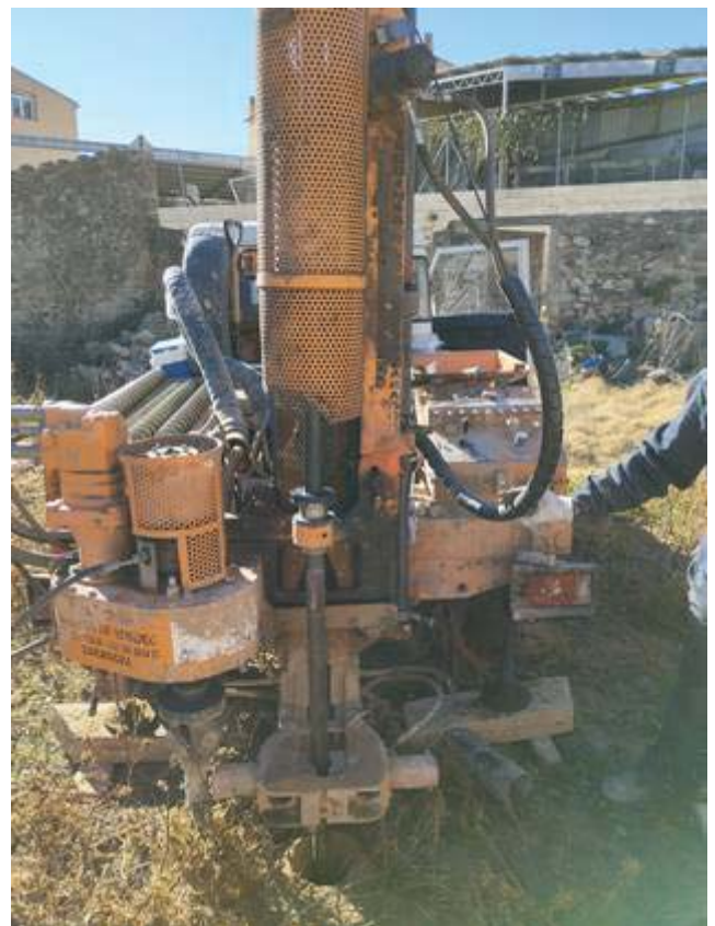
Vistes dels quatre sondeigs realitzats a la parcel·la objecte d'estudi, P-1 i P-2 del tipus DPSH i, S-3 i S-4 del tipus Rotació helicoidal.
