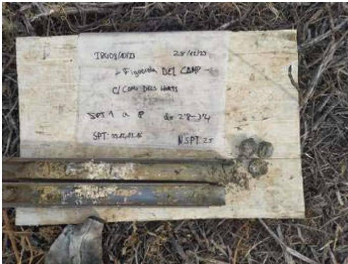
Vistes dels materials del subsòl extrets en un assaig SPT realitzat al llarg del sondeig P-2.
