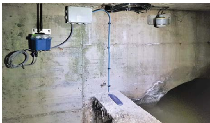
Imatge 2: Exemple d'instal·lació del sistema de monitorització de l'alçada de nivell d'aigua proposat. S'observa una sonda capacitiva a una alçada determinada, el sensor de radar i el datalogger.
