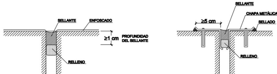
Figura 2.6 Ejemplos de juntas de dilatación
