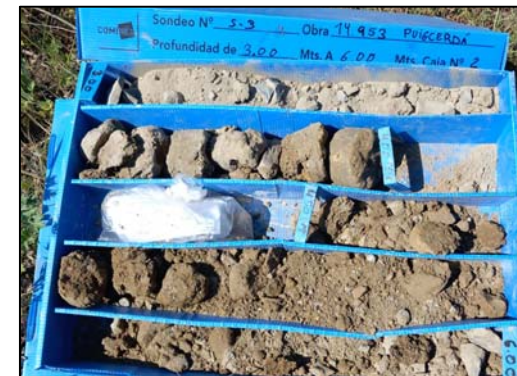
CAIXA N°2. DE 3.00 A 6.00 m. FI DE SONDEIG
