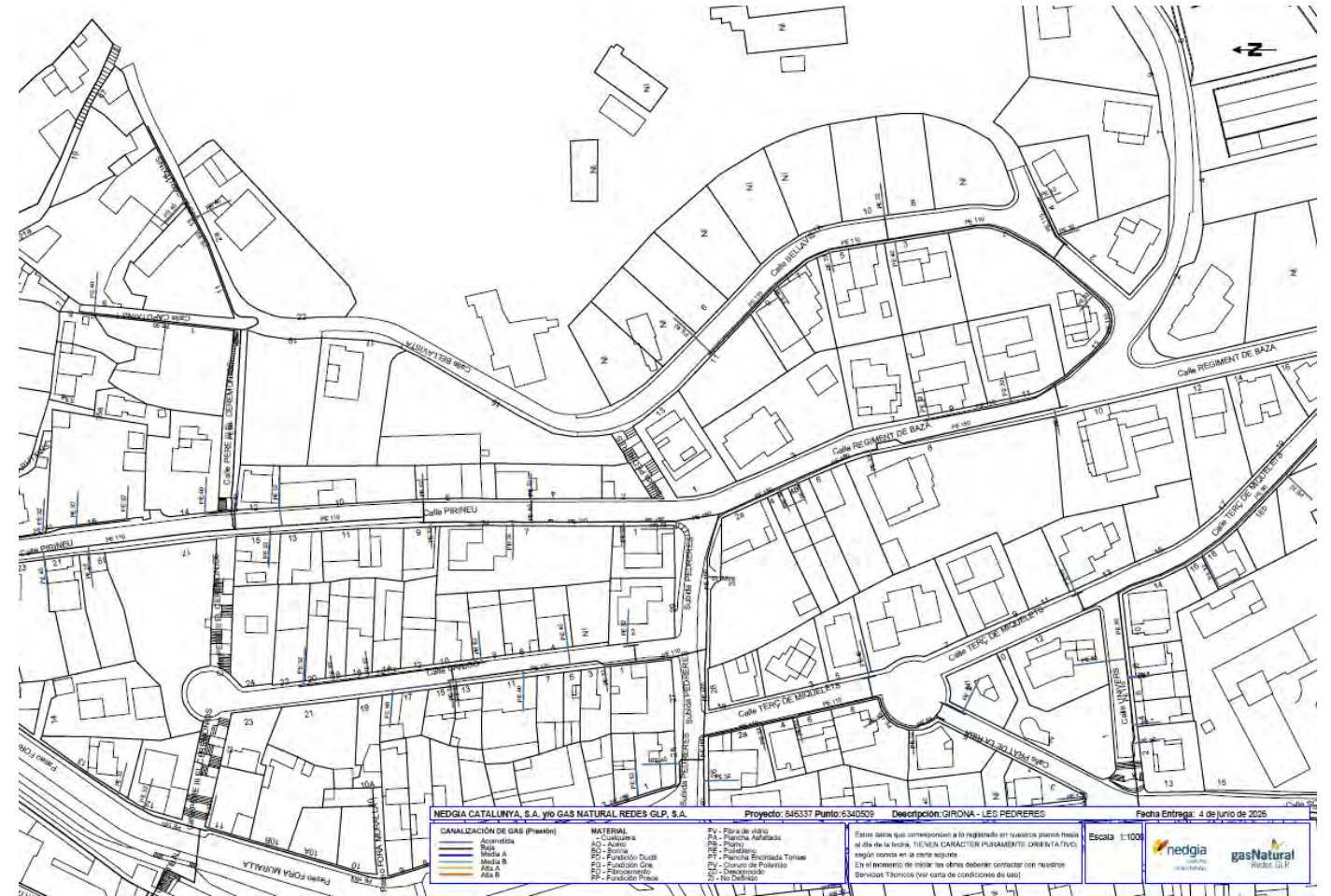
Figura 21. Plànol xarxa de gas existent – ACEFAT.
