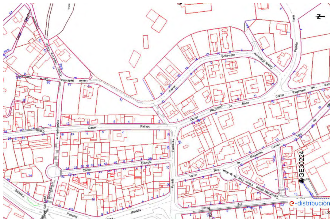
Figura 18. Xarxa existent de mitja tensió - ACEFAT.
