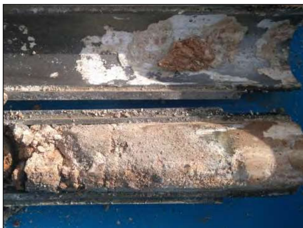
Fotografía 15: S2. SPT1. Detalle de arcilla limosa con gravas del nivel I de Cuaternario cohesivo
