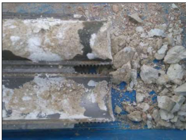
Fotografía 9: S1. SPT2. Detalle de la calcarenita del nivel II de Substrato mioceno
