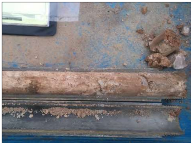
Fotografía 7: S1. SPT1. Detalle de arcilla limosa con gravas del nivel I de Cuaternario cohesivo
