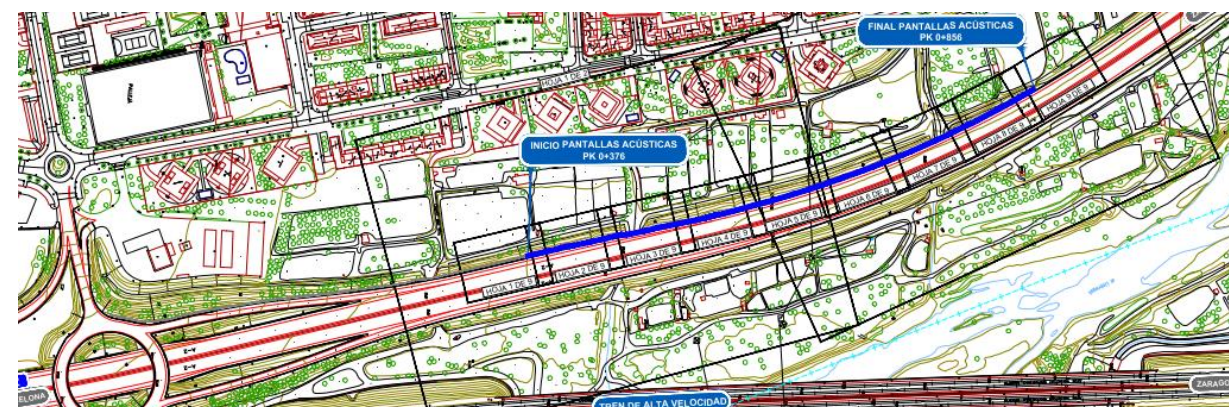
Planta de conjunto del apantallamiento propuesto, de 480 metros de longitud.
