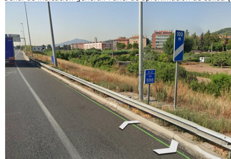
PK 0 + 625 → Señal de indicación general. Panel de aproximación de salida (600 x 1200 mm)
