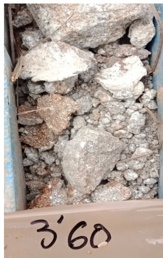
Foto 5. Nivell A. Sorres argiloses blanques, cimentació incipient. Sondeig S-3 de 3,50 a 3,60 metres de fondària.
