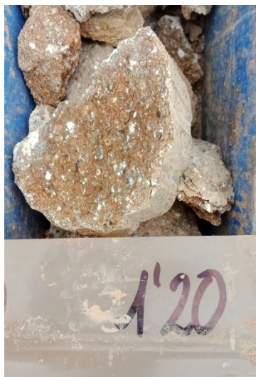
Foto 4. Nivell A. Sorres llimoses marrons amb algunes gravetes. Sondeig S-1 a 1,20 metres de fondària.
