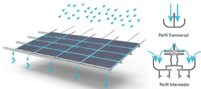
Perfilería utilizada para la recogida del agua
