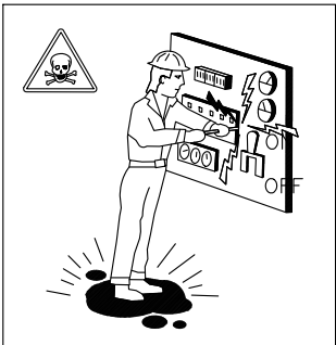
REPARACION DE EQUIPOS BAJO TENSION
