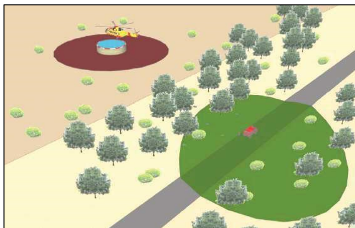
Imatge 15: Esquema de zona de protecció al voltant del punt de càrrega i al voltant del mateix punt d'aigua
