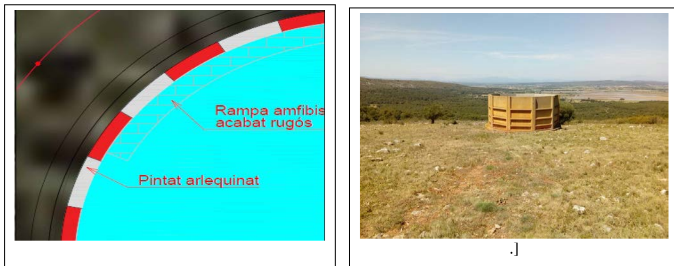
Imatge 26: Arlequinat i exemple de pintura de parets. En aquest cas és un dipòsit prefabricat oxidat.
