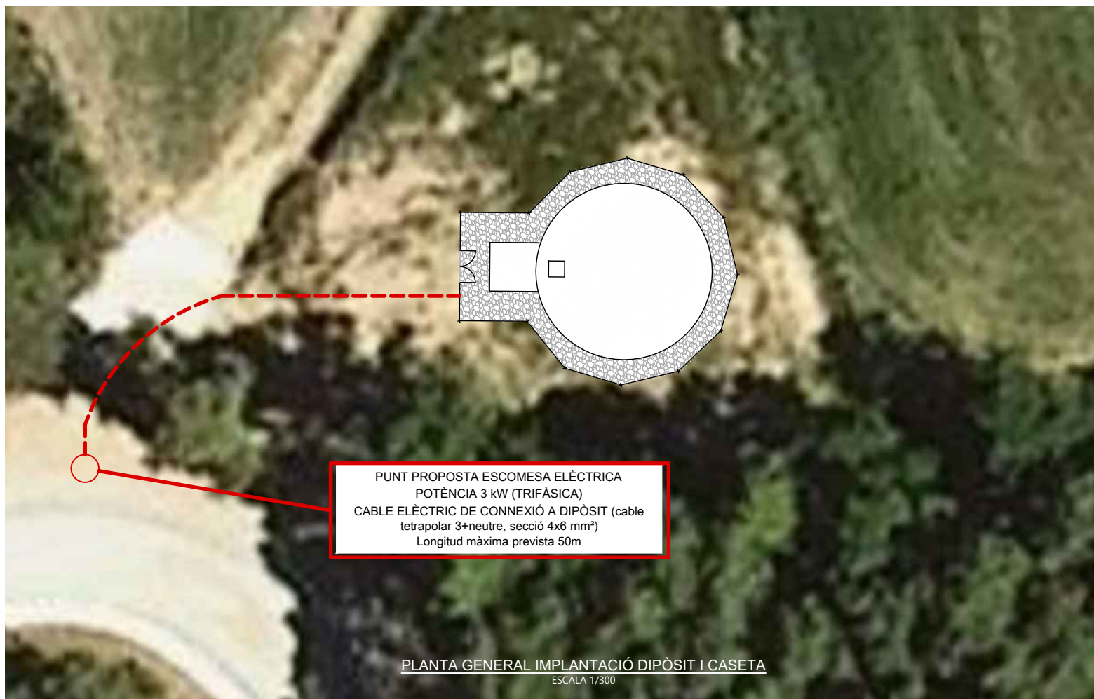
PLANTA GENERAL DIPÒSIT I CASETA ESCALA 1/150
