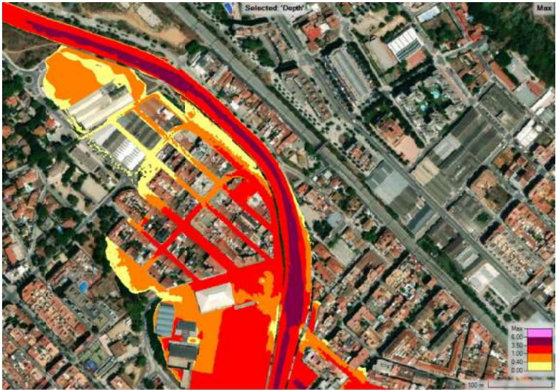
Figura 3.3: Inundabilitat per 100 anys de període de retorn en estat actual.
