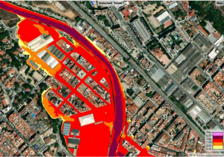
Figura 3.4: Inundabilitat per 500 anys de període de retorn en estat actual.
