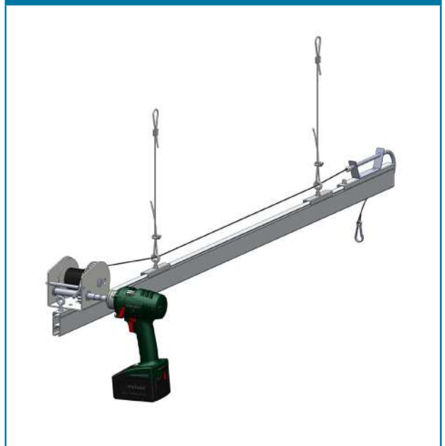
Montaje de guía mediante herramientas autorizadas
