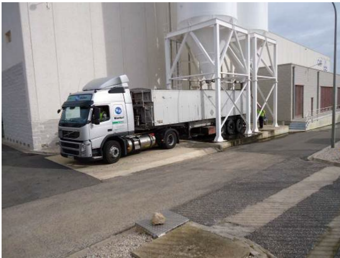
Procés de carga del CAG-E des de les sitges al camió banyera
