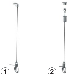
Rockfon tiene dos juegos de suspensión diferentes con un cable metálico ajustable de 1500 mm y un gancho de sujeción de seguridad.
