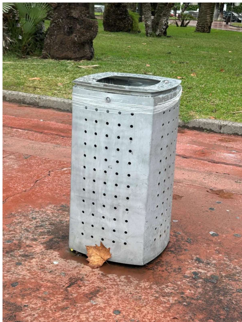
Imatge num 4. Paperera model AMG elaborada amb xapa d'acer de 3 mm amb acabat bicromatat. Capacitat de 57 lts de capacitat amb base central que es fixa mitjançant quatre pernys o cargols M10 que queden ocults. Paperera exterior amb cubeta cilíndrica interior de xapa galvanitzada, tapa abatible i tancament de seguretat. Mides: 9,5 cm x 100 cm. (diam.x alt).
