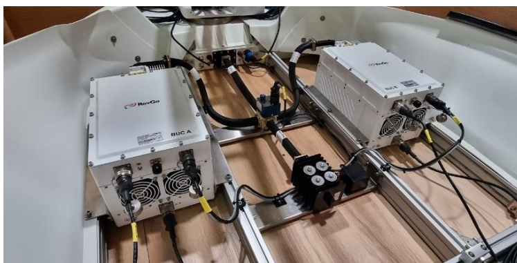
Detalle parábola, amplificadores y guía de ondas
