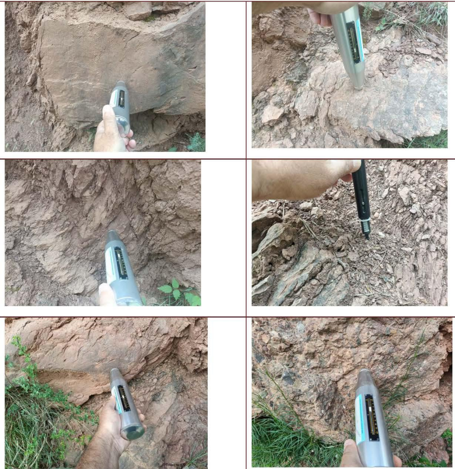
Fig 2. Assaig de resistència a la compressió simple amb Martell d'Smitdh (escleròmetre). Estacions geomecàniques E1, E2, E3 i E4
