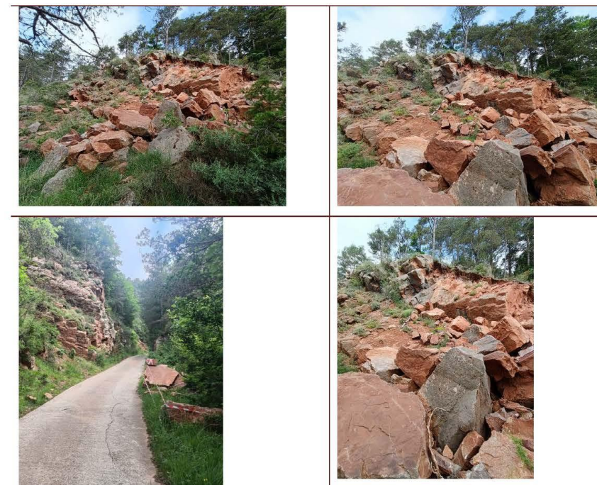
Fig. 5. Dipòsits de caiguda. A la part superior imatges d'esllavissament planar en roca situat a uns 10 metres per sobre de la pista, amb dipòsits de caiguda fotrmats per acumulació de grans blocs, que es troben inestables i es poden mobilitzar. A la part de sota blocs dispersos a la pista producte de desprendiments puntuals.
