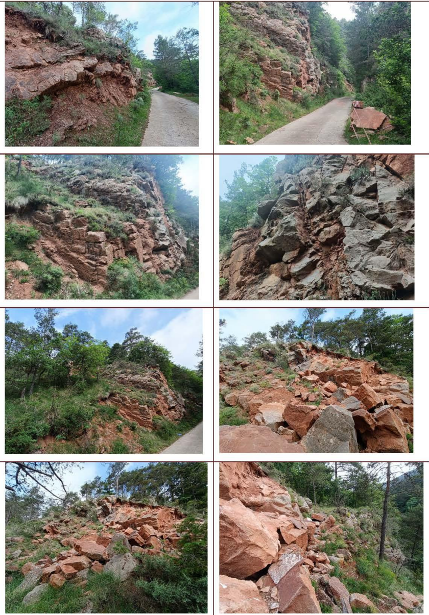
Fig. 3. Aflorament de talussos analitzats amb sistema de juntes de discontinuïtats (diàclasi i estratificació) i dipòsits de desprendiments i caiguda de blocs. Estacions geomecàniques E1, E3, E3 i E4
