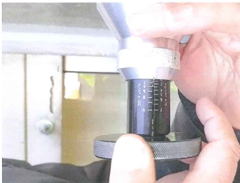
Proceso de puesta en tensión del aparato Elcometer.
