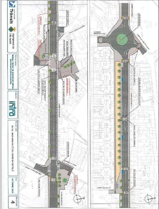
PLANTA TIPUS PAS DE PEATONS ELEVAT
