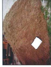
Fotografia 3. Detall de les sorres extretes de la calicata C-2.
