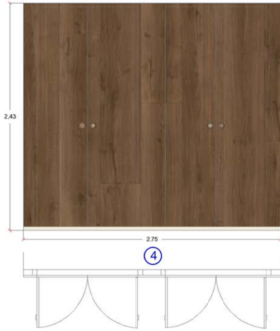
Portes armaris quadre elèctric (1ut)
