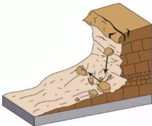
Figura 2. Esquema gràfic de despreniment de roques
