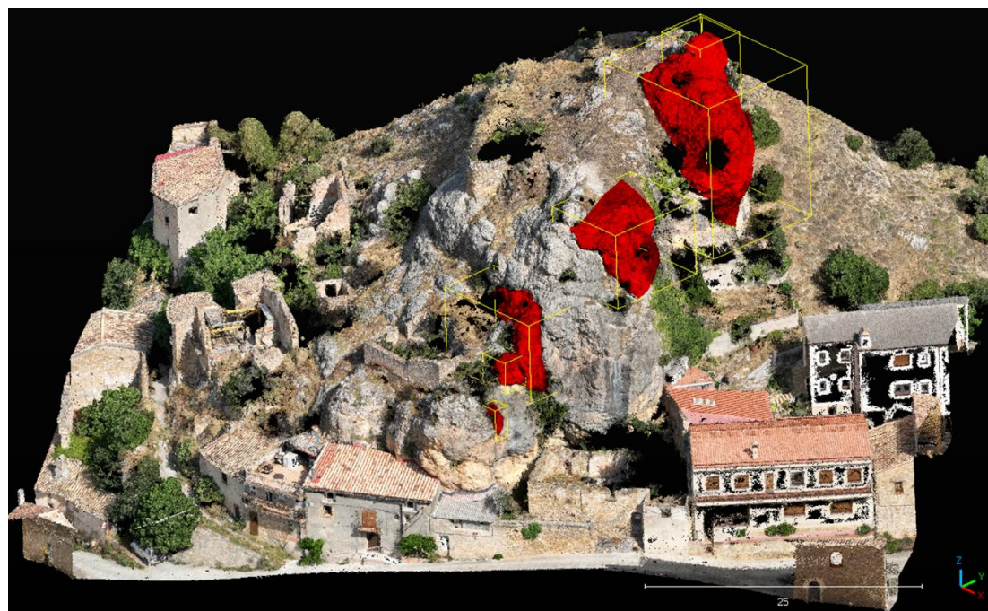
Fig. 8. Blocs identificats a partir de la conjunció de discontinuïtats.
