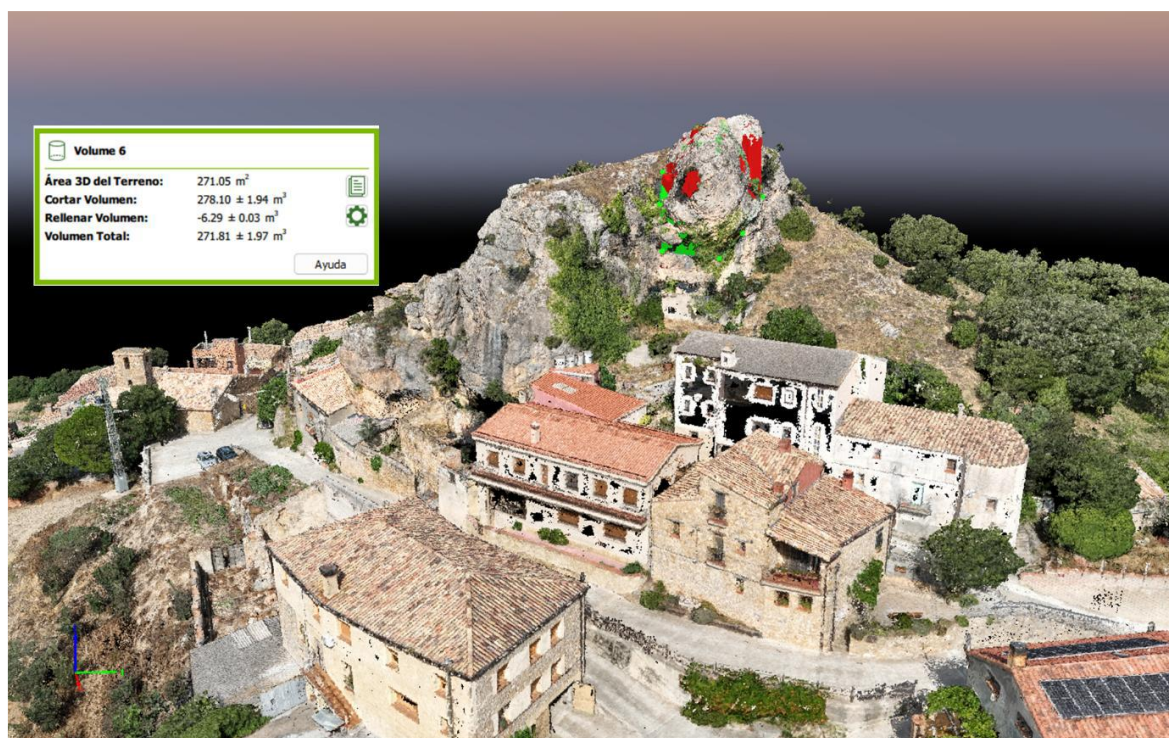
Figura 5. Fotografia del model 3D obtingut amb fotogrametria aèria i identificat de les zones inestables amb els seus volums.
