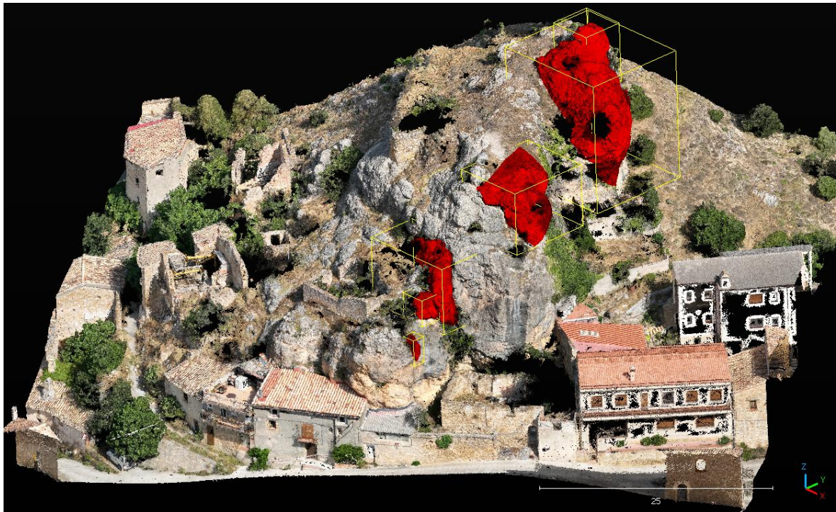
Figura 4. Fotografia de d'identificació de les zones potencialment inestables sobre el model 3D.
