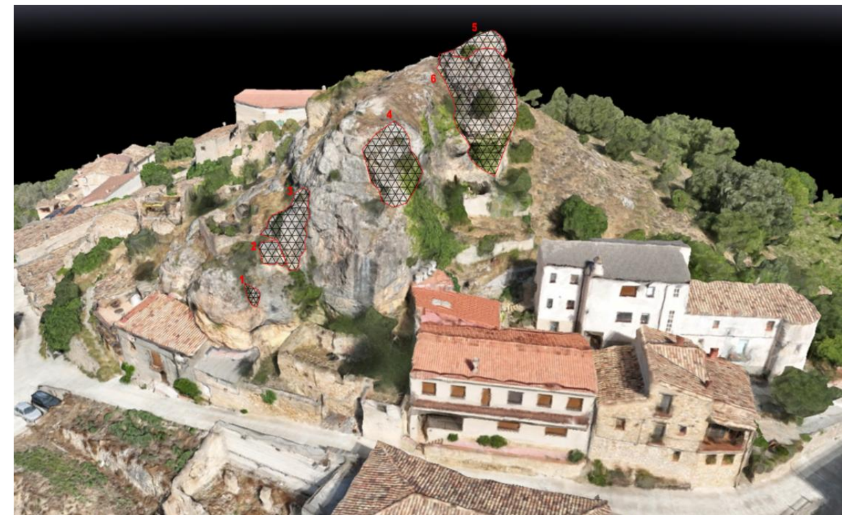
Figura 8. Sistema de sosteniment malla Spider S-3
