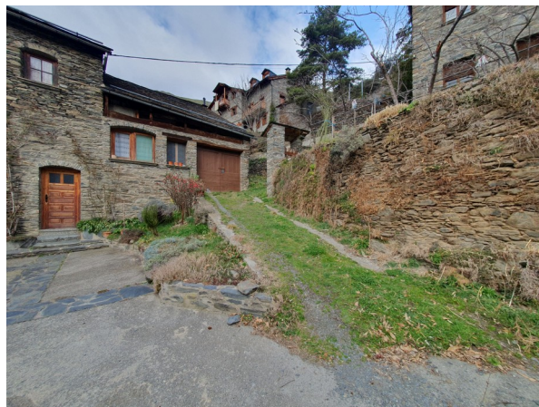
Actuació 10. Carrer a pavimentar. Tram de vianants (dreta) amb pedra natural com l'actualment present al poble rejuntada amb morter, i la part per de la rampa per vehicles (esquerra) amb formigó amb fibres i nervi central de pedra.
